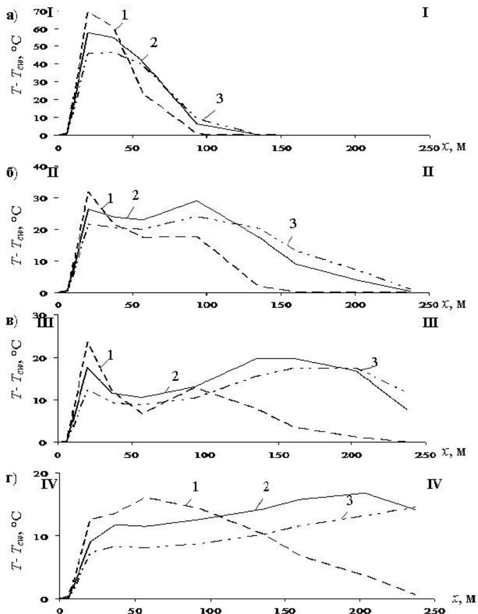
Рисунок 5 – Превышение температуры подземных вод в обводненных породах над кровлей угольного пласта при его сжигании по различным профилям (I – I, II – II, III – III и IV – IV) спустя  $t = 30$  сут (а),  $t = 100$  сут (б),  $t = 180$  сут (в) и  $t = 245$  сут (г), при угле падения водоносного горизонта: 1 – 10°; 2 – 20°; 3 – 30°
